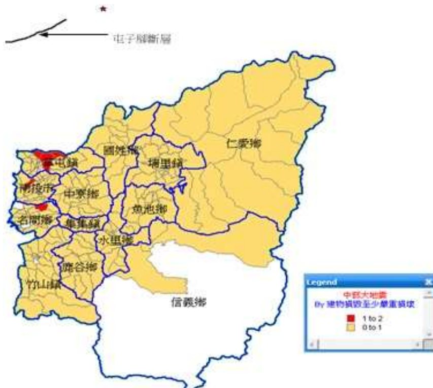
圖 24 模擬屯子腳斷層錯動建物損毀分布圖
